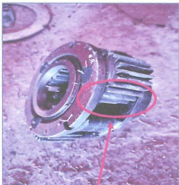
IMAGEM DETALHADA DO CONJUNTO DO SINCRONIZADO DANIFICADO
