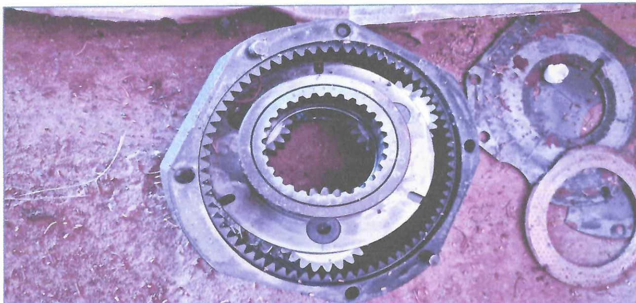
IMAGEM DETALHADA DA COROA REDUZIDA DANIFICADA
