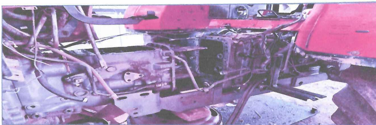
IMAGEM DO TRATOR AGRÍCOLA COM SEU SISTEMA DE TRANSMISSÃO JÁ DESMONTADO
