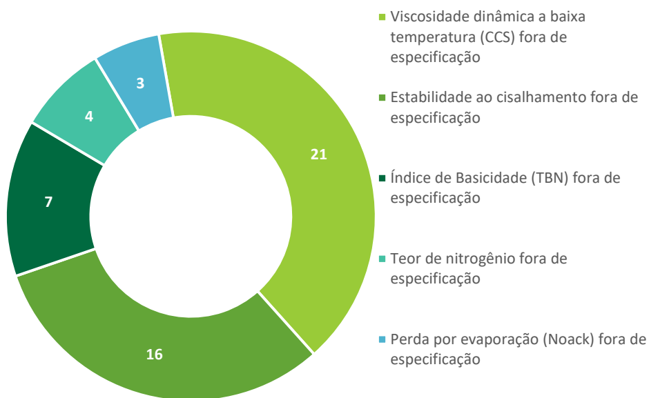
Figura 8. Número de amostras não conforme para os ensaios Índice de Basicidade (TBN), Viscosidade dinâmica à baixa temperatura (CCS), Estabilidade do Cisalhamento, Perda por Evaporação (Noack), Infravermelho, Teor de nitrogênio e Ponto de Fulgor.
